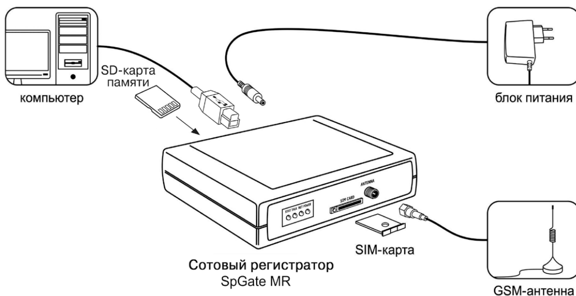
Рис 6.1 Подключение сотового регистратора SpGate MR
